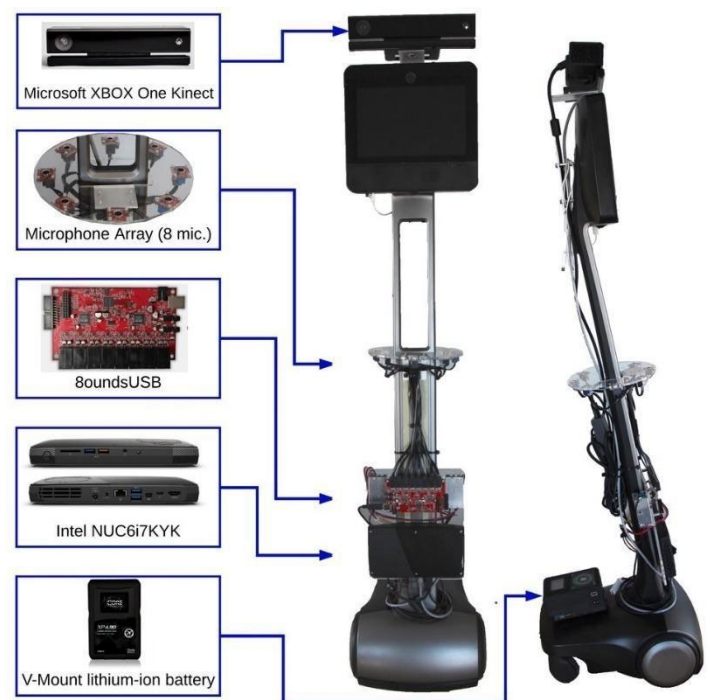
Figure 1 - SEQ Figure \* ARABIC1 : Photographie et description des différentes parties du Télérobot
