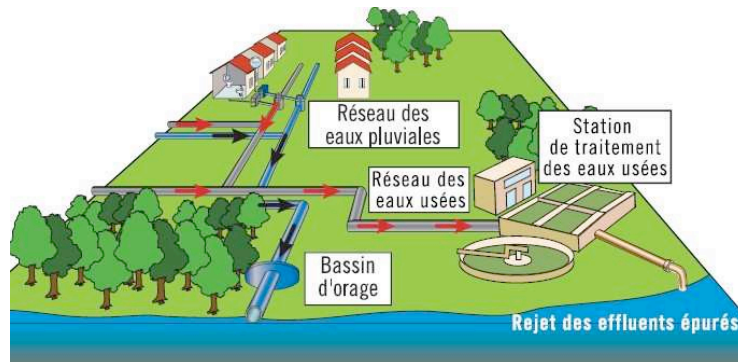
Figure 2 : Réseau des ouvrages d'assainissement (Source : INERIS, 2012)
